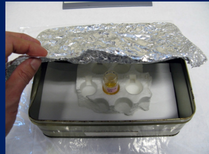
湿気・埃を避け 一晩放置し酸化プロピレンを揮発
