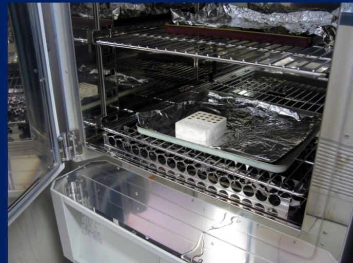
30℃ 8 時間, 45℃ 8時間, 60℃ 48 時間と段階的に温度上昇させ重合促進
