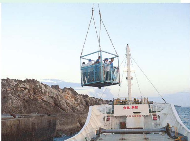
北大東島の港。北大東島は船を接岸できないため、貨物も人もクレーンで移動する。
