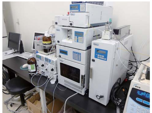
薬物濃度測定機器 (高速液体クロマトグラフィー)
